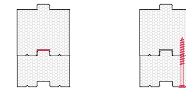
Der Aufbau erfolgt im praktischen Nut-Federsystem.
